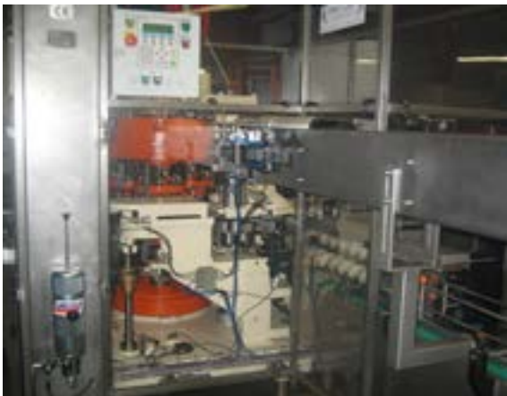
Angelus 50 P (Sonderausführung): - CE-Schutzhaube, Zentralschmierung, Siemens S7, Deckelmagazinverlängerung, Gerader Einlauf Tisch mit Doppelschnecke
