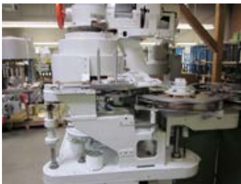
Original – Deckelabstapelung und Dosen-einlaufkarussell
