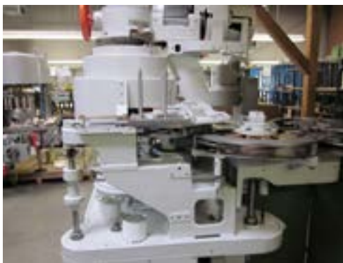
Original – Deckelabstapelung und Dosen-einlaufkarussell
